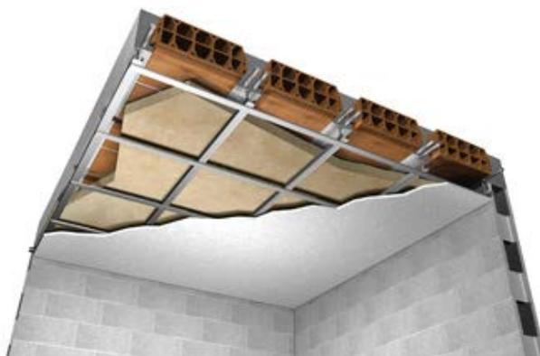
I materiali impiegati sono generalmente polistirene espanso, fibre di vetro o fibre naturali - quali sughero - e a seconda del materiale usato lo spessore da impiegare per ottenere un risultato vantaggioso dal punto di vista economico varia da un minimo di 4 cm fino a 10-15 cm (ma esistono limiti tecnici di spessore applicabile).
