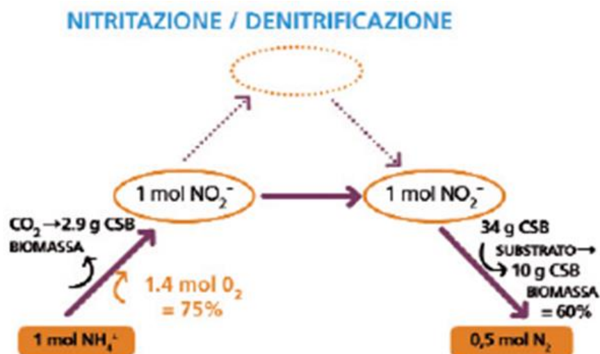
Figura 37– Schema ciclo dell'azoto con la nitritazione
